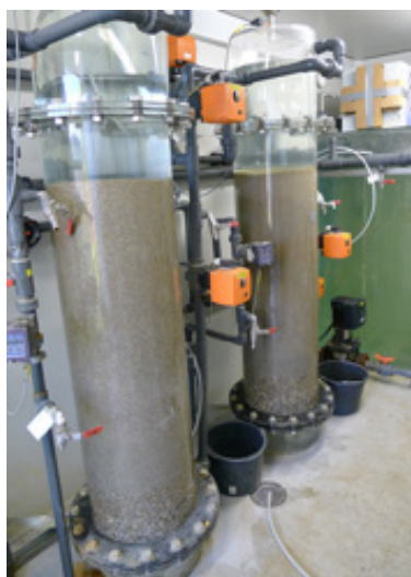
FIGUR 2 - DE TO BIOLOGISK AKTIVE FORSØGS-SANDFILTRE (40 CM I DIAMETER, SERIELT FORBUNDNE)
