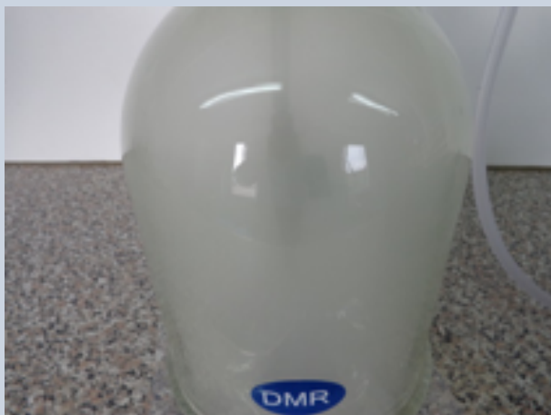
Røgfylt klokke under forsøget
