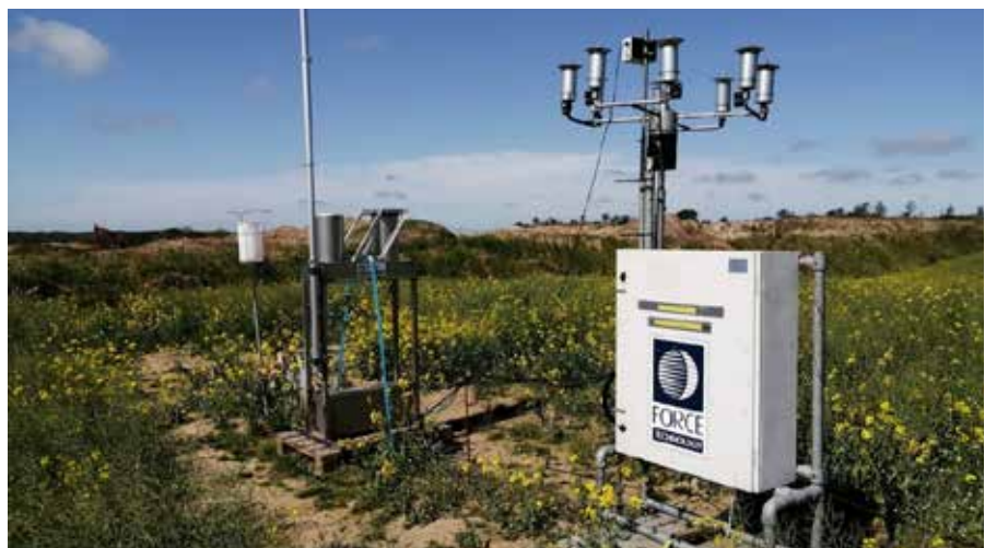
FIGUR 2 OPSTILLING AF STØVMÅLEUDSTYR VED GRUSGRAVEN I HELSINGØR.
