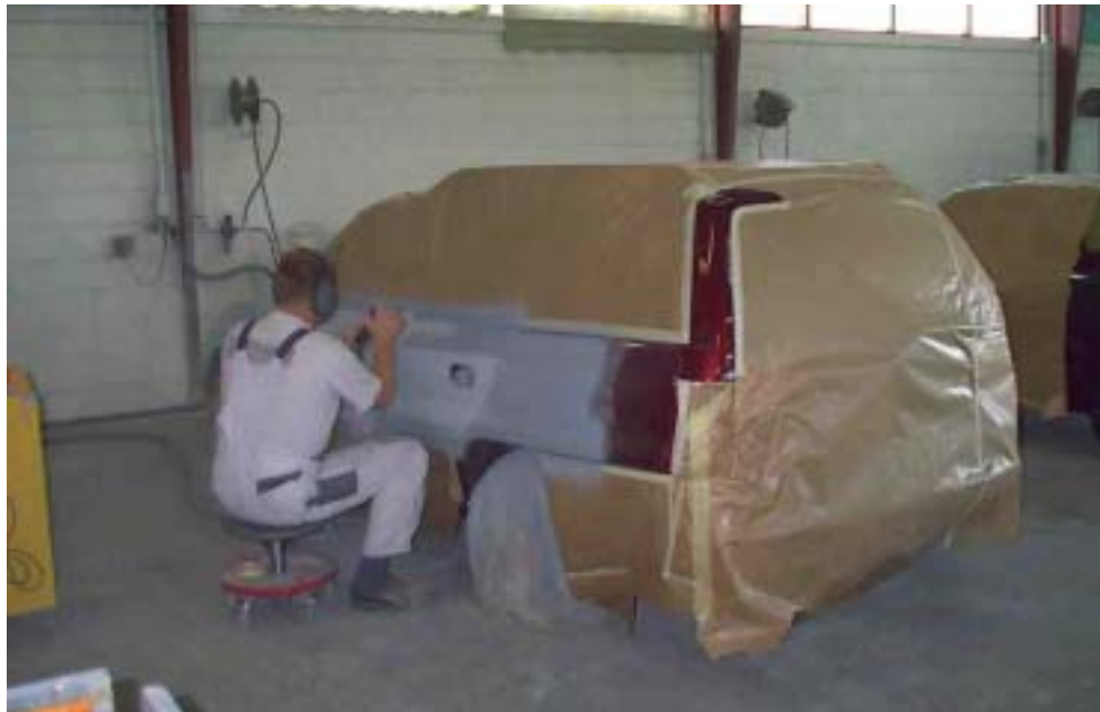
Figur 4.3 Grovslibning med rystepudser i forbehandlingshal.
