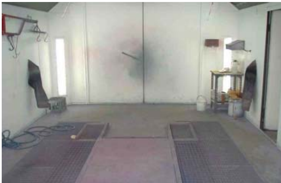
Figur 4.6 Kombineret sprøjte- og tørrekabine (kombikabine).
