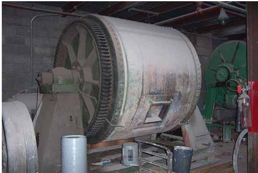
Figur 4.7 En rivemølle til pigmenter. Kilde: Fra http://www.americanaai.com .
