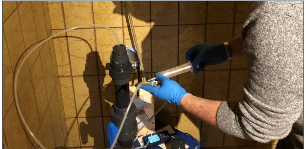
Figur 2.4. Manuel prøveudtagning med 200 ml glassprøjte.
