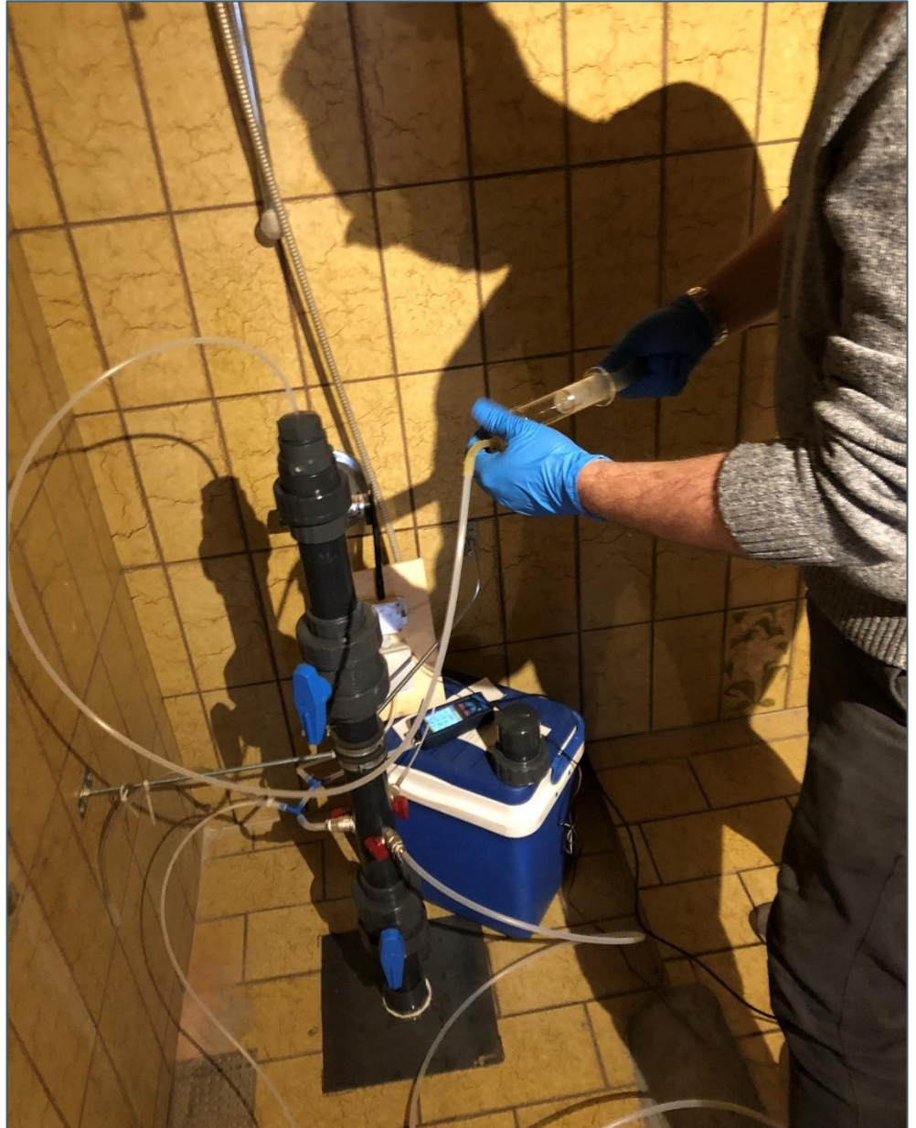
Figur 3.6. Prøvetagning af luft i afløbssystemet bag målepunkt LS1005. Prøven bliver udtaget optil ca. 3 m bag "vandlåsen".
