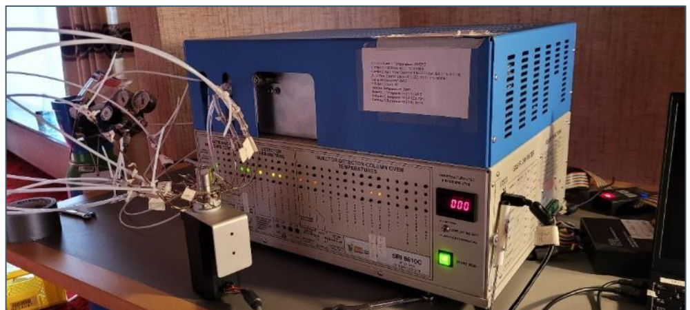
Figur 2.2. Gaschromotograf (GC) med en DELCD og PID-detektor (SRI 8610C).
