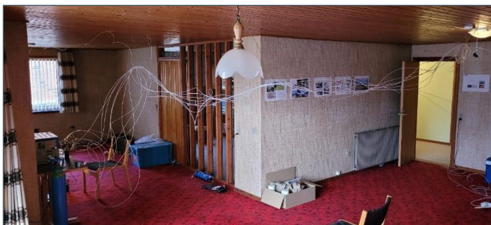
Figur 2.18. Føringsvej for prøvetagningsslanger ophængt via loft.
