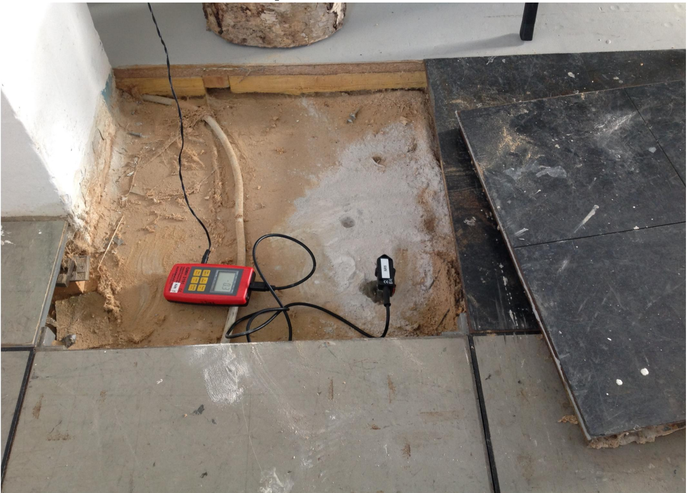
Måling af differenstryk med Greisinger måler, Område 1.
