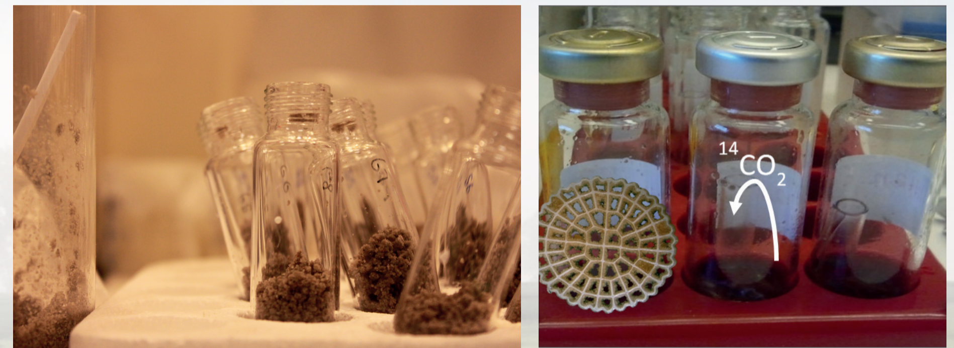
Figur 3. Laboratorieforsøg at klarlægge hvordan pesticid-nedbrydningen stimuleres bedst muligt
