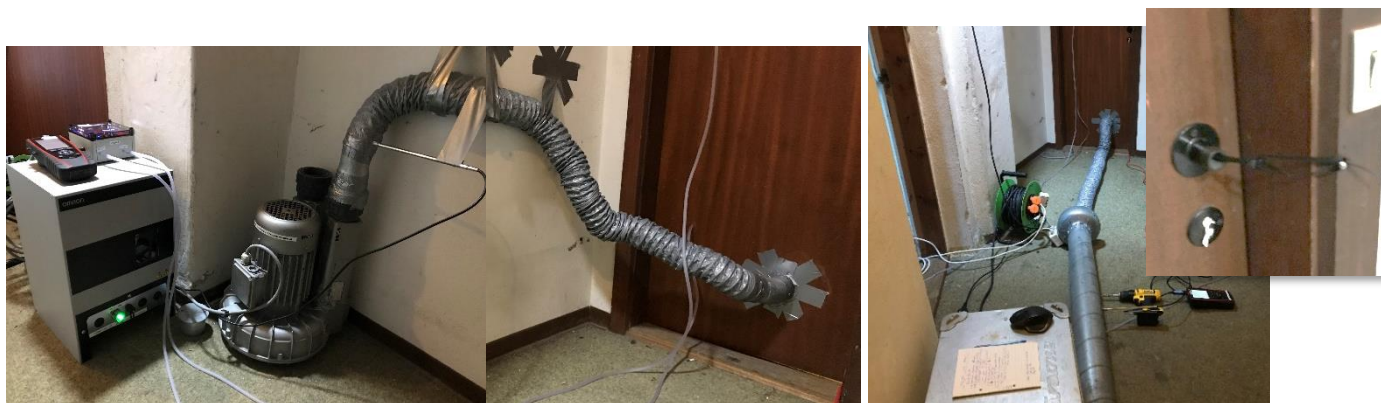
Figur 3.17 Fotos af forsøgsopstillinger til tillægsprojekt 1 (kontrolleret undertryk). Venstre to fotos = test med stor sidekanalblæser. Stort foto til højre = test med in-line ventilator. Indsat foto til højre = dørlukning med strip.
