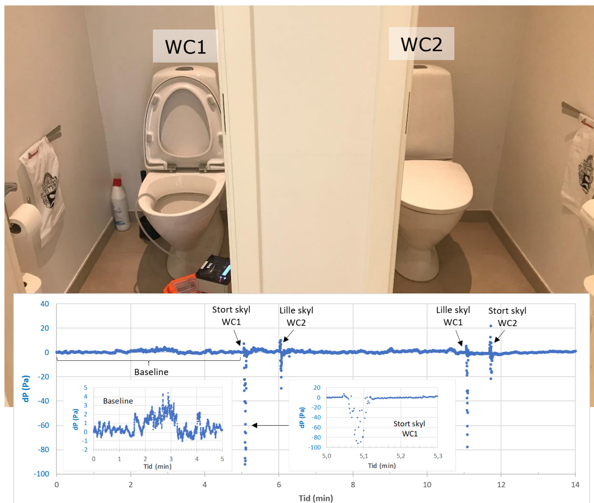
Figur 3.25 Logning af differenstryk bag vandlås på gulvmonteret WC (WC1) på en anden lokalitet. Loggerdata fra træk-og-slip test indsat, ved hhv. store og små skyl på WC1 og WC2. I grafen er indsat en forstørrelse af differenstryk (dP) for hhv. baseline (til venstre) og et stort skyl (til højre). Positive differenstryk indikerer trykgradient fra faldstamme mod indeklime.
