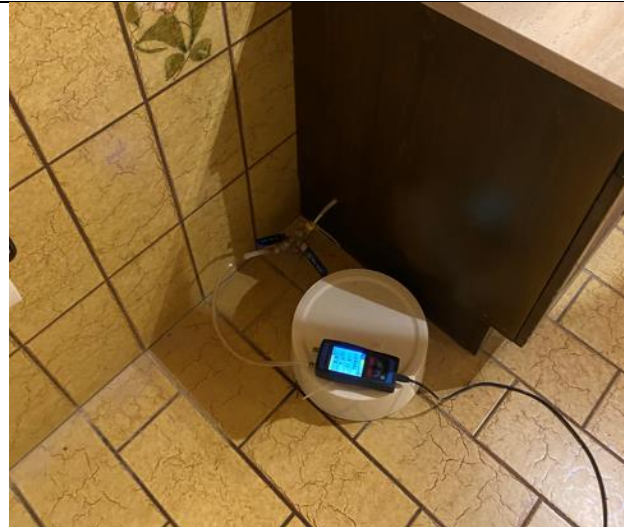
Foto 6: MP1013, hvor der ses påvirkning af differenstryk ved test 1.
