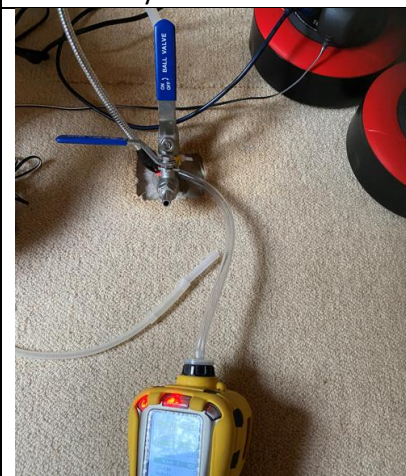
Foto 11: Nærbillede MP1003, ved måling ved gennemføring ses påvirkning ved test 2.
