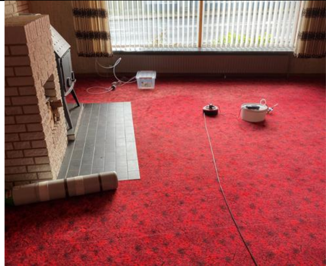
Foto 4: MP1010, hvor der ses påvirkning af differenstrykket under test 1.
