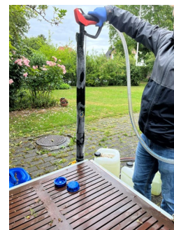
Kolonneforsøg med GraphySorber som filtermateriale. Foto: K/S OilRem
