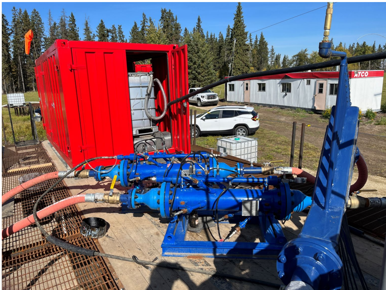
M-Crack system i brug for oparbejdning af råolie til mere sand fri olie. Hydrodynamisk metode baseret på vandtryk, til brug i en kontinuerlig proces Foto: K/S OilRem
