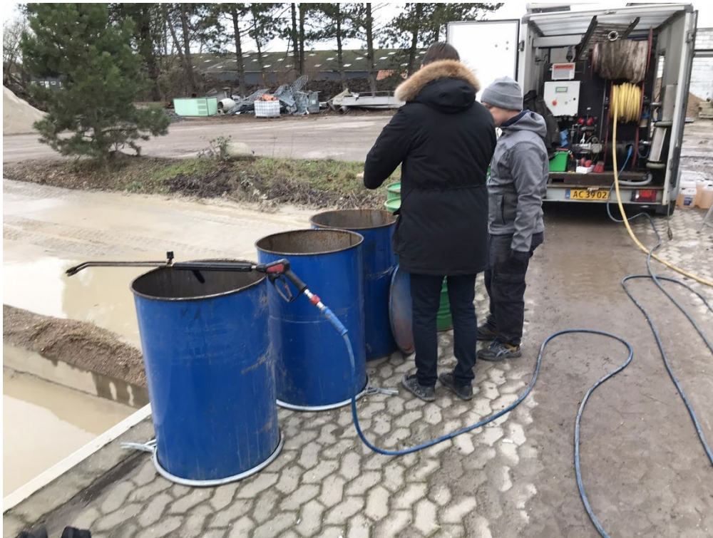
Forberedelse af barrel-tests med hydro-blaster med tryk op til 500 bar. Foto: K/S OilRem
