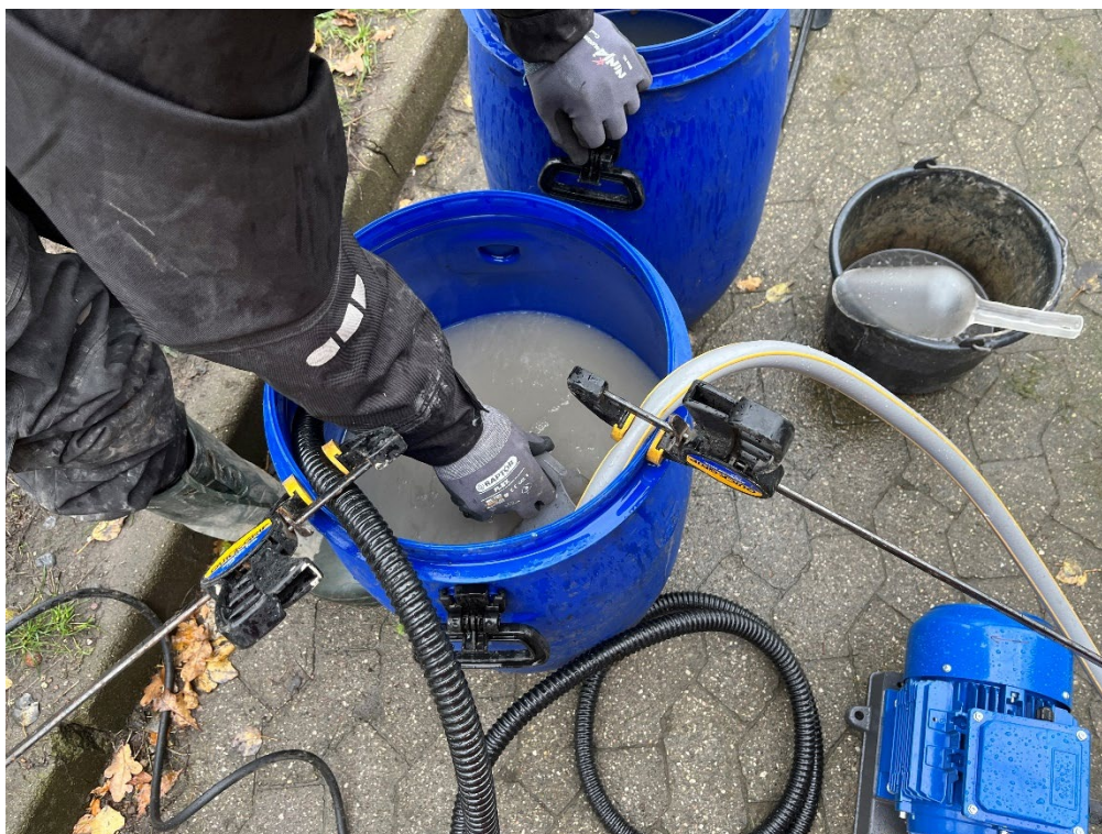
Med mikro- og nanobobler i vandet, dannes et hvidt svæv, der trækker PFAS op i skummet. Her kun vand. Foto: K/S OilRem
