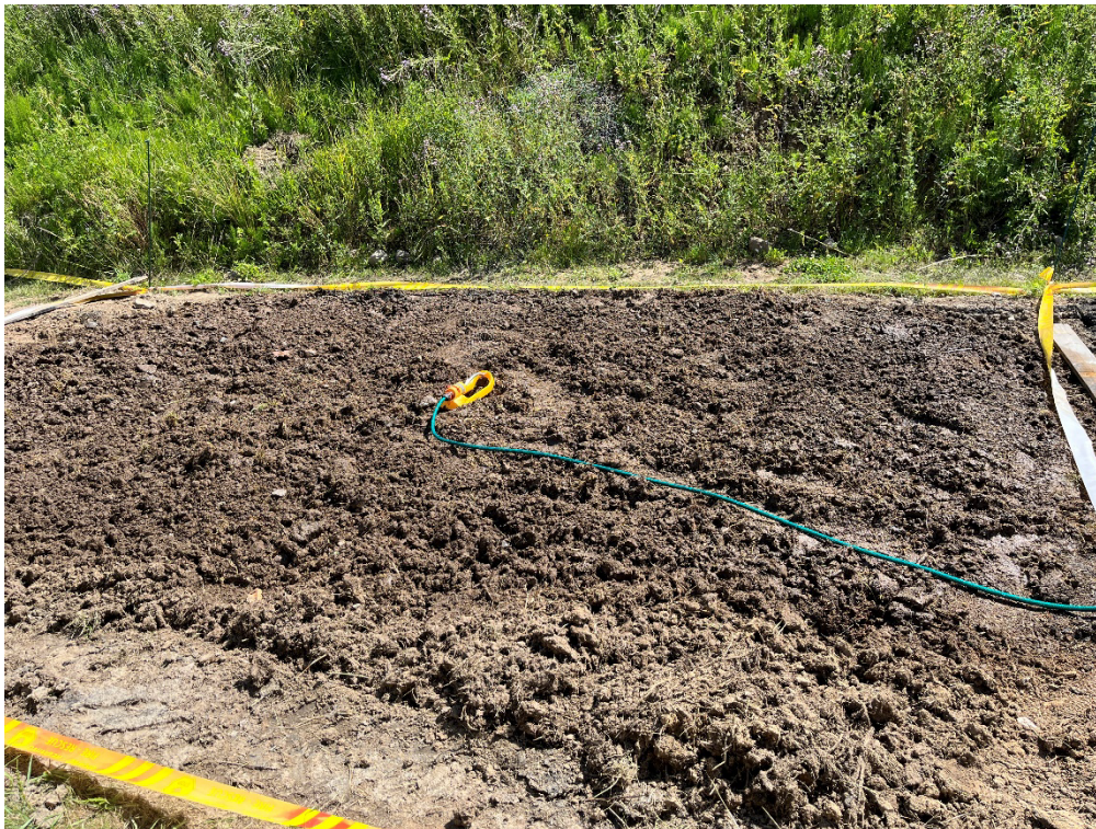
Vanding af de enkelte felter gøres med svingende spreder, for at opnå en så jævn vanding som muligt. Foto: K/S OilRem
