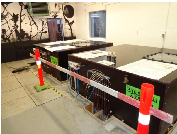
Billede 37: Forsøgsopstilling "kul i gulv". Skifte i gulvkonstruktion fra støbt beton foran port (forgrund) til vinylfliser i stålrammer på flisefødder (baggrund).
