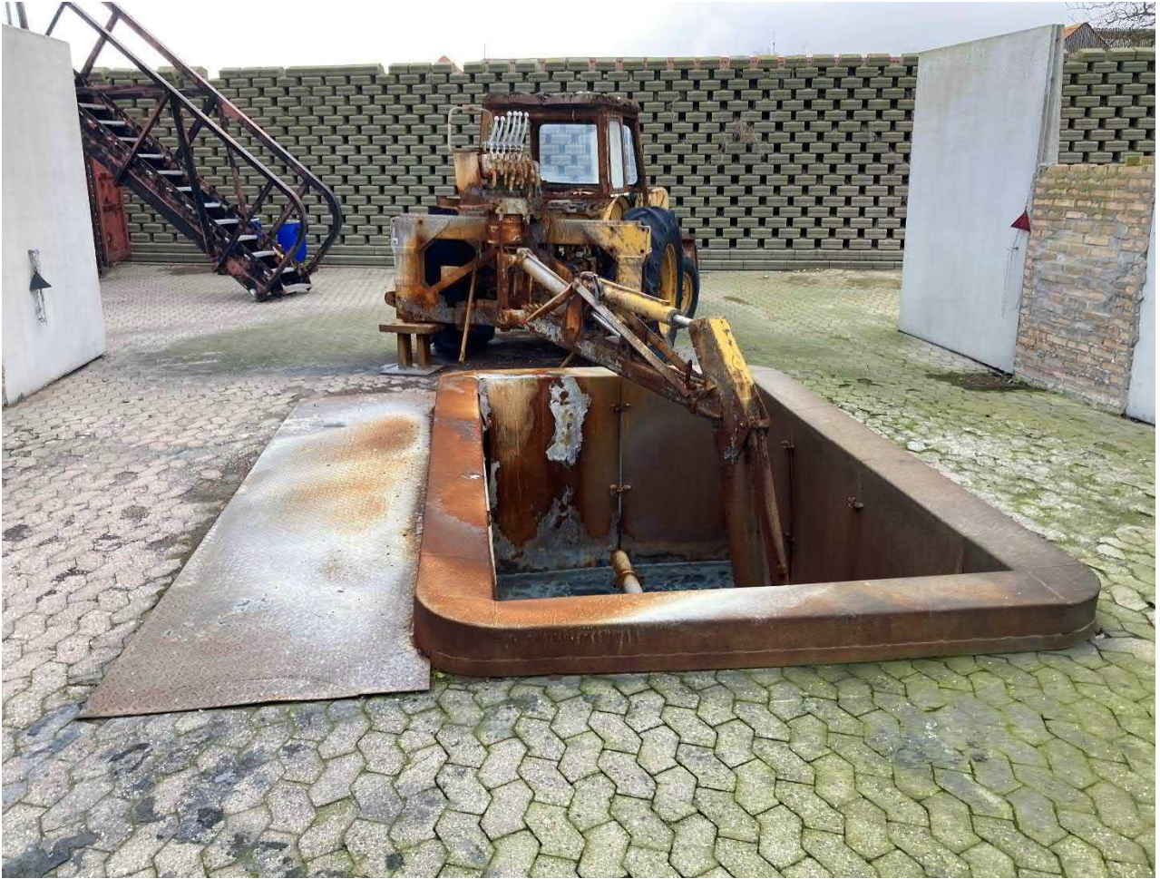
Foto 15. Øvelse i slukning/håndtering af overgravede gasledninger. (Gasøvelsespladsen)
