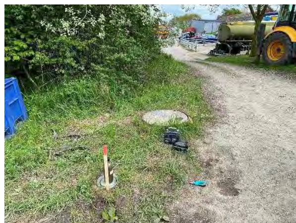
Foto 4: Vandprøvetagning fra B4, placeret ved utæt brønd øst for oplagsplads mod nord.
