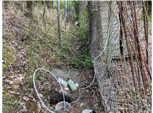
Foto 28: Vandprøvetagning fra B29, som er ved hegnet mellem brandskolen og den sydlige ende af baghaven i nr. 13.
