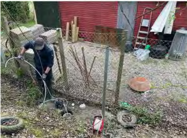
Foto 27: Vandprøvetagning fra B28, som er ved hegnet mellem brandskolen og den sydlige ende af baghaven i nr. 14.
