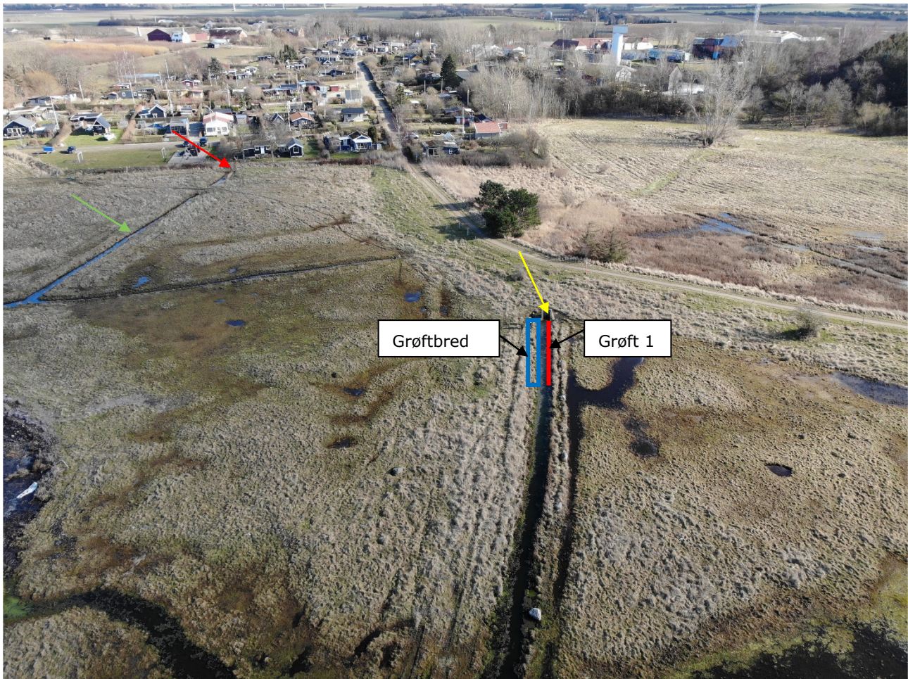
Figur 4.2: Ved den gule pil ses grøft efter udløbsbygværk ved afløb fra RESC. Her er prøverne "Grøftbred" og Grøft 1" udtaget. Ved den røde pil ses det sted, hvor prøverne "Drængrøft", "Dræn 1" og "Drængrøft, sediment" er udtaget. Ved den grønne pil ses den omtrentlige placering af det område, hvor prøven "Drængrøft, vandprøve" er udtaget.
