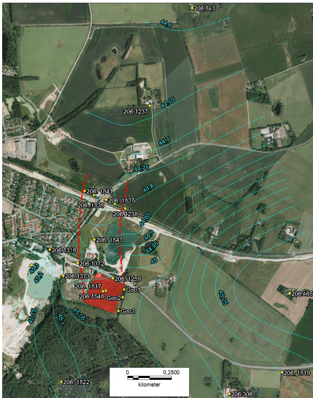
Figur 3-2 Tolket potentialebillede for Torckilstrup-formationen, 2. januar 2013 (m DVR90). Pejlepunkter er markeret med stjerner. Kortet er tolket ud fra synkronpejlingen 2. januar 2013, supplerende tolkning i 206.1843 m.fl. 27. februar 2013 samt præcisionsnivelement udført den 14. februar 2013.
